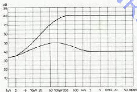
Modtagerens AM signal-støjafstand i dB som funktion af antennespændingen.
