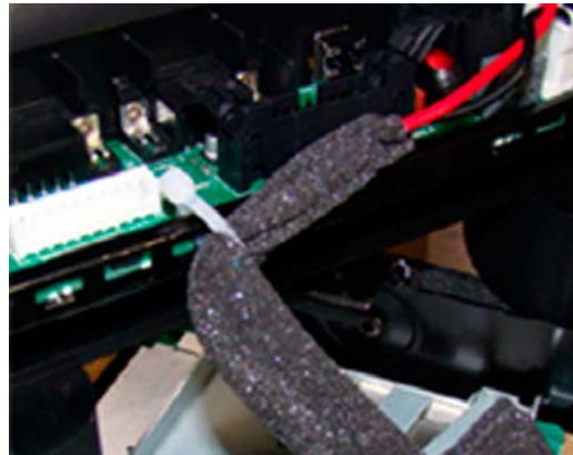
I/O PCB Tie-Wrap Loop
