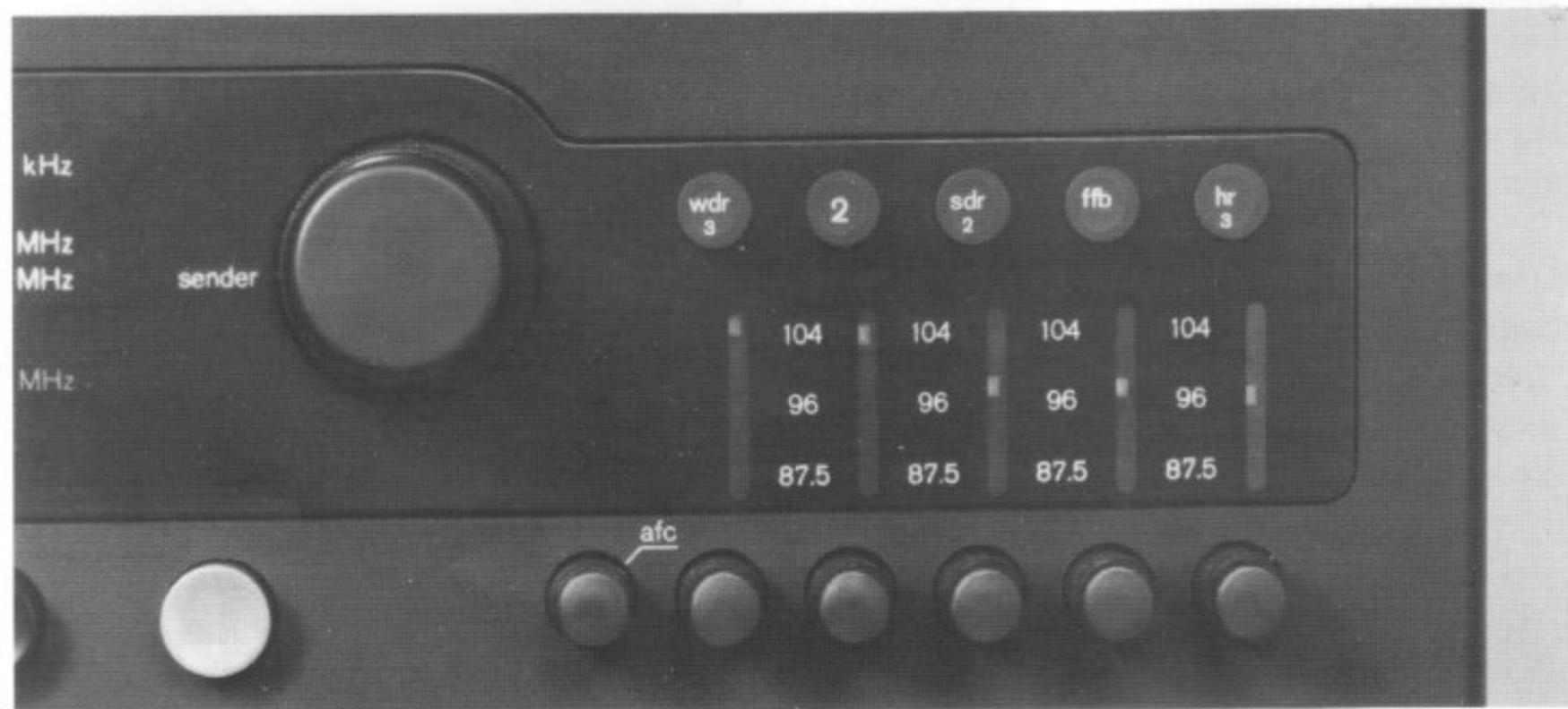
trolle) eingeschaltet werden. Eine Automatik, die Ungenauigkeiten in der Sender-einstellung elektrisch korrigiert. Die Automatik soll ausgeschaltet bleiben, wenn der gewünschte Sender wesentlich schwächer als ein eng benachbarter Sender empfangen wird, da sie sonst möglicherweise die Einstellung auf diesen stärkeren Sender hinüberzieht.
