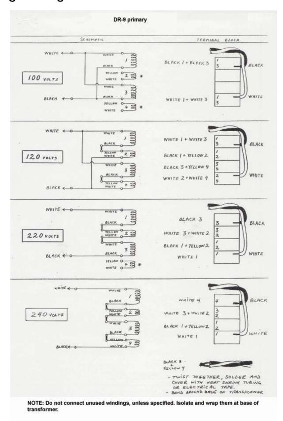
Fig. 1 – 120v AC wiring
