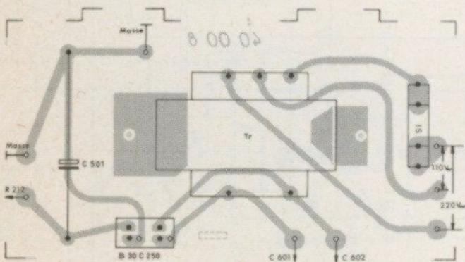
Fig. 2 Spannungswandler-Platte
