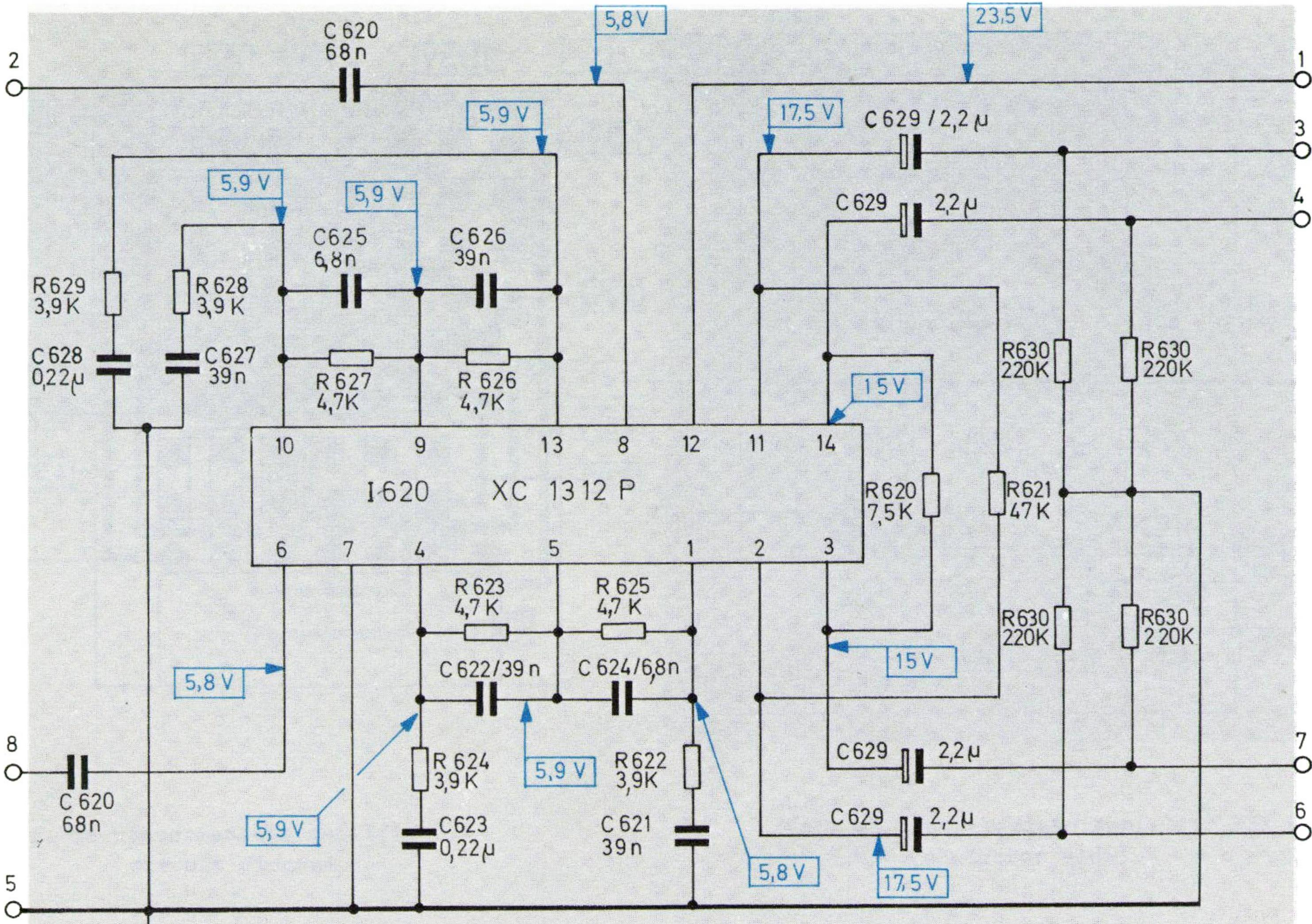
Fig. 29 SQ decoder 232 461 (conductor side)
