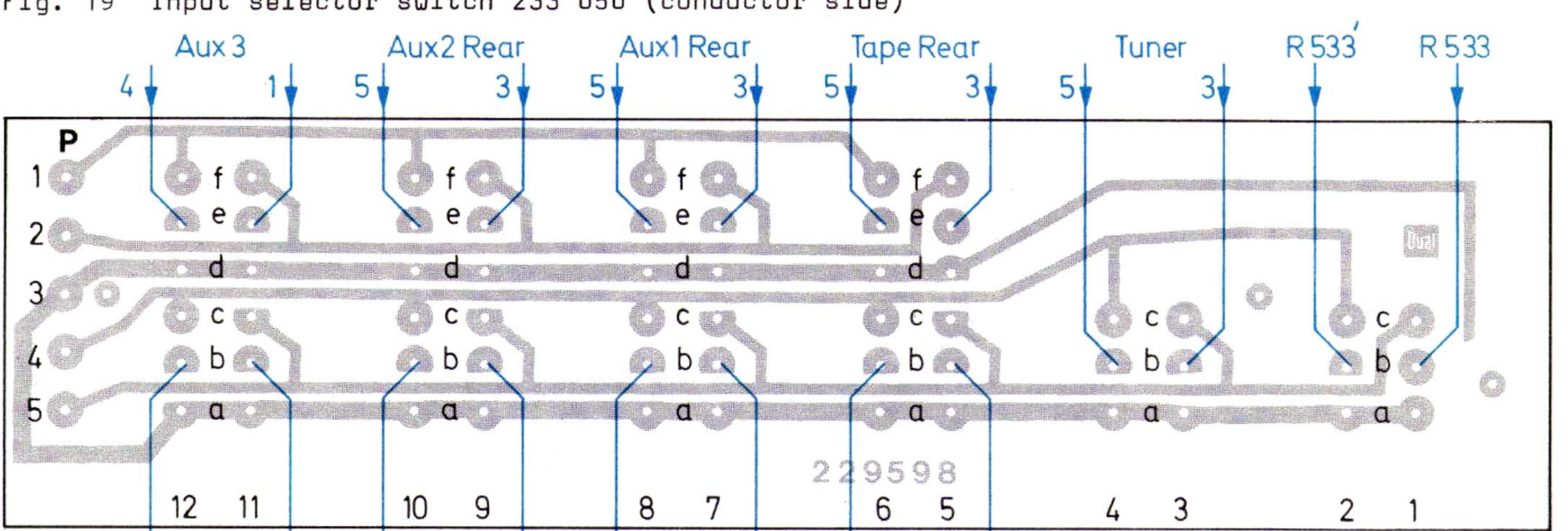
Fig. 19 Input selector switch 233 050 (conductor side)
