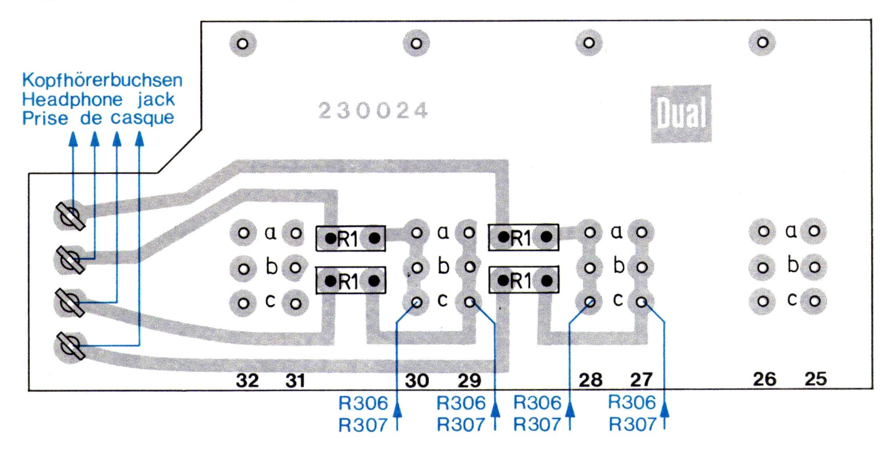
Fig. 21 Volume control 233 051 (conductor side)
