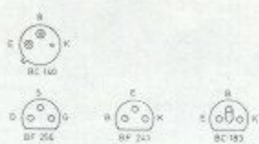
Transistoren von der Anschlußseite gesehen Transistors as seen from the connecting side Transistors vu du côté des connexions
