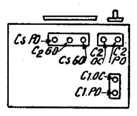
Disposition des pièces sur le châssis branchement du récepteur pour les différentes tensions du secteur, branchement du dynamique et disposition des ajustables.
