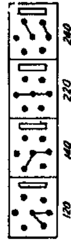
Au-dessus : Plaque de commutation de la tension du secteur avec la valve CY2. Au-dessous : Plaque de commutation avec la valve CY1.
