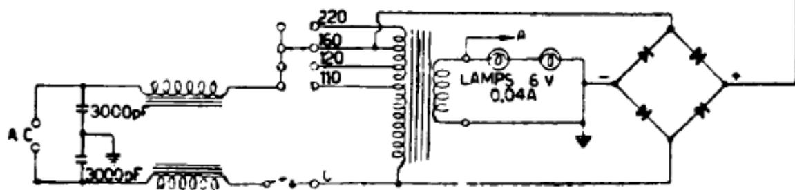
**SICART-EMERSON - Mod. 803. Apparecchio di minime dimensioni con sola gamma onde medie e con due finali in controfase. Media frequenza 455 kc/s. 3 watt di uscita.**
