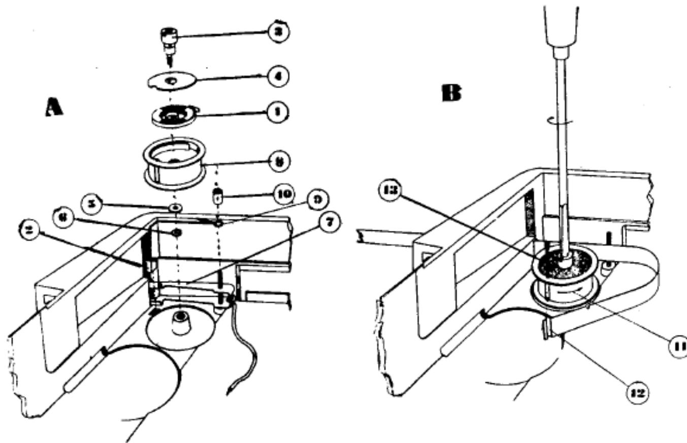
SICART - EMERSON - Mod. A 730 YB 126. *Operazione da eseguire per lo smontaggio e il montaggio dell'antenna avvolgibile.*
