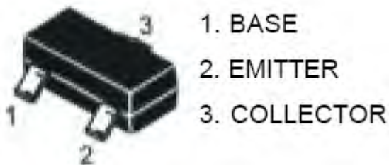
2N3906; PNP Transistor(SOT23)
