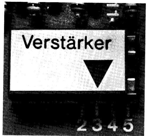
Bild 16 VERBUND-SCHALTUNG 2-5 GERÄTE Fassung mit Codierstecker
