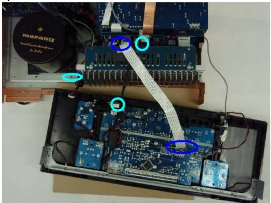
Change FFC : 17P 1.0mm(AV8003 A : Blue) : CN63(DSP) <--->CN64(FRONT) Disconnect the CN89 (Headphone PWB) and CN17(DSP).
