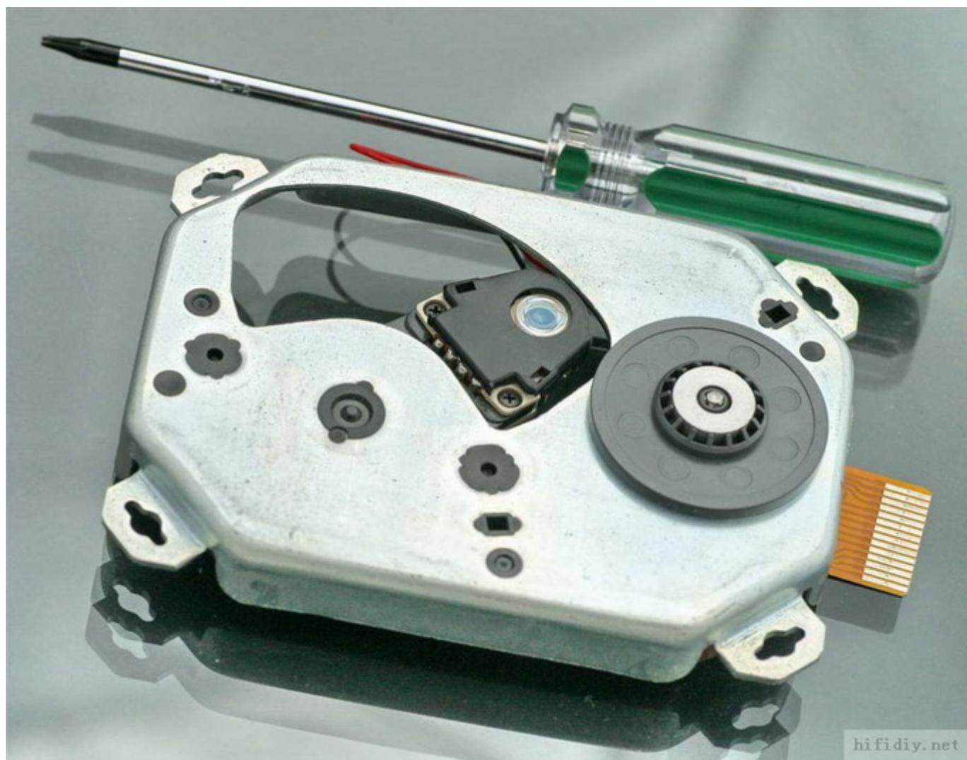
经过了从 CDM1 到 CDM3 几代摇臂光头技术的发展，CDM9 的结构和性能已经相当成熟。在所有 PHILIPS 摇臂系列光头中，CDM9 的结构是最紧凑、最简捷的，其通用性、一致性和可维护性也是最强的。在我所见过的 CD 镭射机芯中也是最容易拆解和重新组装的。
