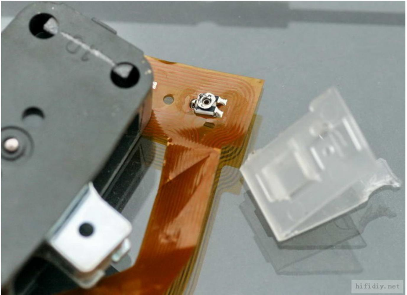
用改锥将被磁力吸合在一起的摇臂磁铁的上下两个软铁片分开，这样就可以将摇臂线圈与摇臂磁铁分离。看一下摇臂磁铁，其结构与硬盘的磁头寻迹磁铁非常相似，原理也是一样的。
