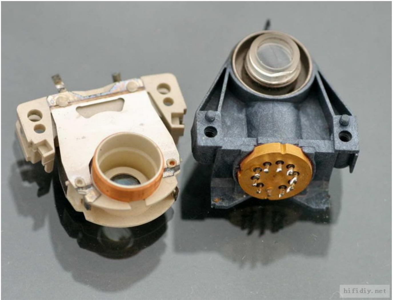
接下来就要对 CDM9 进行破坏性的拆解了。用钳子将胶接在激光头壳体上的激光管用尽力拉出，将激光管与激光头分离，可以看到激光头壳体上残留的红色的胶接物的痕迹。
