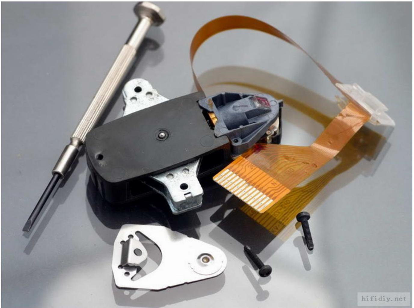
再看一下激光强度调节电位器。这个电位器被直接焊接在柔性 PCB 排线上，由白色半透明塑料卡子所保护并最终固定在 CDM9 的外壳上，这个电位器是整个 CDM9 光头唯一可以调整地部分。这个电位器通过调整回馈到伺服系统激光监视二级管所检测到激光电压的幅度达到调整激光强度的目的。这个电位器在出厂时经过专用激光头检测设备调整，除非本导体激光器严重老化，一般不需要再重新调整。
