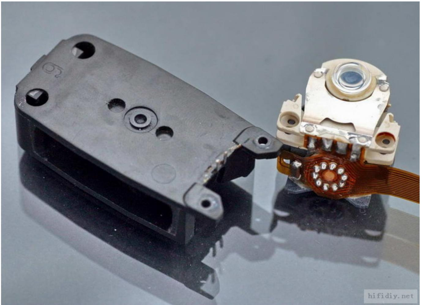
用电烙铁将柔性 PCB 排线从激光头和物镜线圈组上拆掉，再用手轻轻将物镜线圈组与激光头分离。可以清晰地看到聚焦线圈，与扬声器的音圈类似。还可以看到安装在激光头的磁靴上的另一组非球面透镜。从现在往前所有的步骤都是可逆的，完全可以装回去并且不需要做任何调整，当然，这也是 CDM9 在结构上的高明之处。
