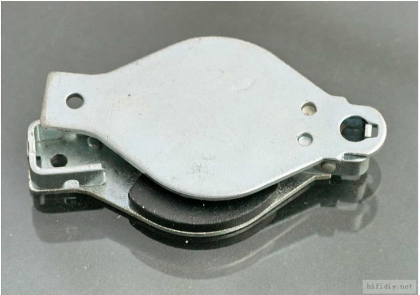
让我们再看一下除去磁铁后的摇臂。激光头固定在摇臂线圈的塑料框架上。摇臂线圈、聚焦线圈和激光头的引线全部从侧面通过柔性 PCB 排线引出。请注意，这个排线是整个 CDM9 光头最脆弱的部分，因为没有可替换的配件，如果排线内部有电路折断，这个 CDM9 光头就基本报废了。
