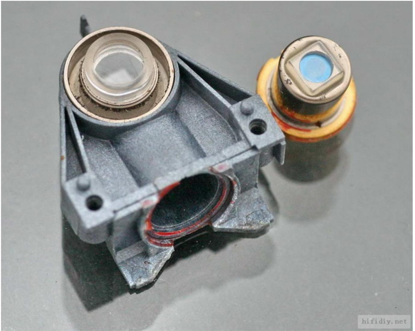
将激光管的顶部放大，可以看到顶部中央的分光镜。这是一个非常精密的光学元件，全靠它让反射回来的激光偏离一个特定的角度准确地聚焦在激光检测器上。这个分光镜的安装角度非常精密，需要专门的仪器来调校，并用特别的胶水粘在激光管上，只有在 PHILIPS 的工厂内才能进行。
