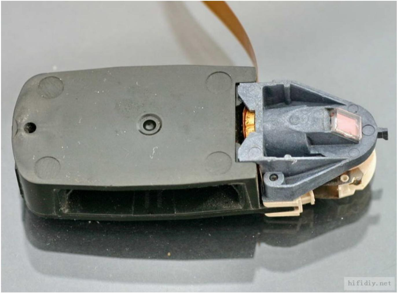
下面我们看一下由两颗十字螺丝固定在摇臂线圈壳体上的激光头。物镜、聚焦线圈与激光头是一体的。物镜由上下两层不锈钢弹片与激光头相连，物镜下面带有聚焦线圈，两层弹片又是聚焦线圈的引出线。物镜由纯光学玻璃制成，上面带有招牌式三瓣形的镀膜，据说这种镜头是蔡司的。物镜的位置受两颗十字螺丝固定，悬停位置由弹片决定，伺服系统开始工作后，物镜作上下运动，在聚焦电路的驱动下始终跟踪聚焦于 CD 碟片的平面上。
