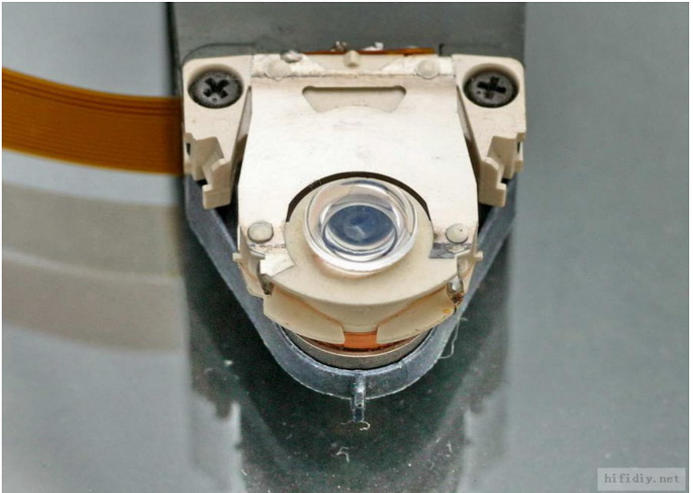
用镊子将黑色的激光头物镜保护罩取下，再用十字螺丝批将固定激光头的两颗螺丝卸下，并用电烙铁将摇臂线圈与柔性 PCB 的连接点断开（请注意防止静电），激光头与摇臂线圈就分离了。可以看到整个摇臂线圈由黑色工程塑料精密注塑而成，线圈被固封在黑色的壳体内。这个线圈与硬盘的磁头寻道线圈类似。线圈的引出线在壳体侧面与激光头的交接处，方便焊接在固定于激光头上的柔性 PCB 上。摇臂的上下两个轴承也在壳体上。
