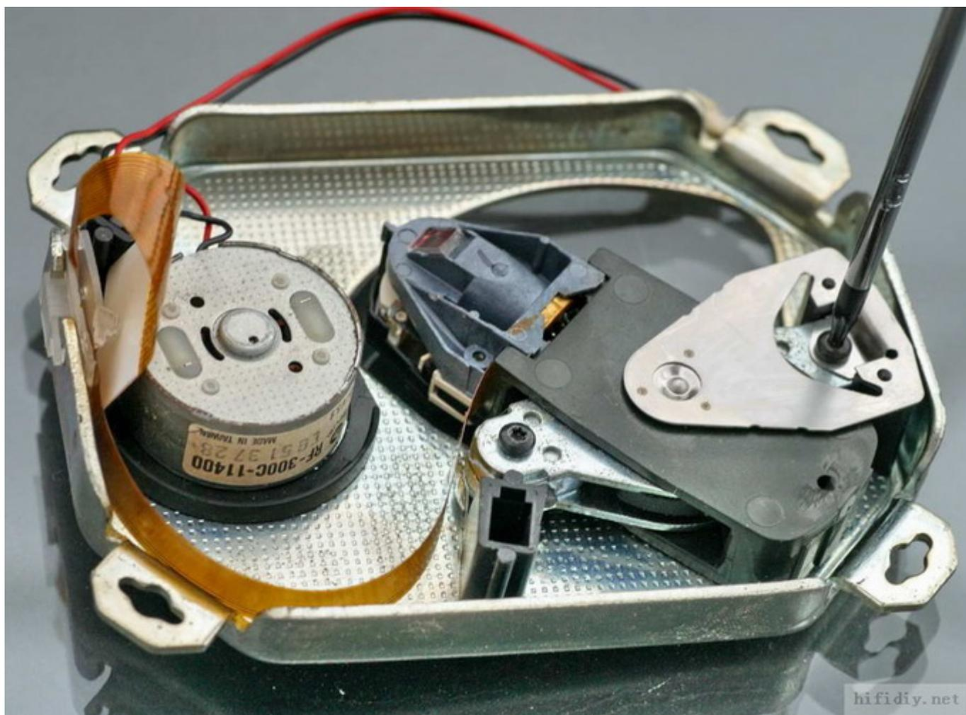
现在，我们可以看到，整个 CDM9 的摇臂就完整地拆下来了，而机芯就只剩下电机和铁壳了。
