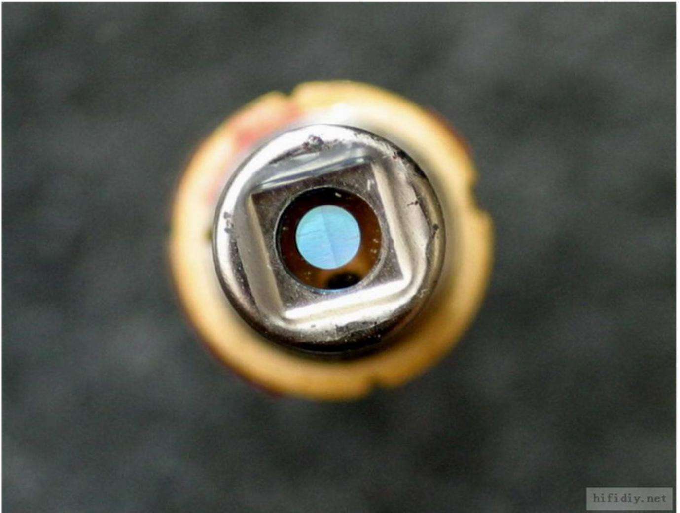
用小刀小心割掉分光镜四周的胶水，取下分光镜，现在可以看到一个顶部带有镀膜玻璃窗口的激光管。
