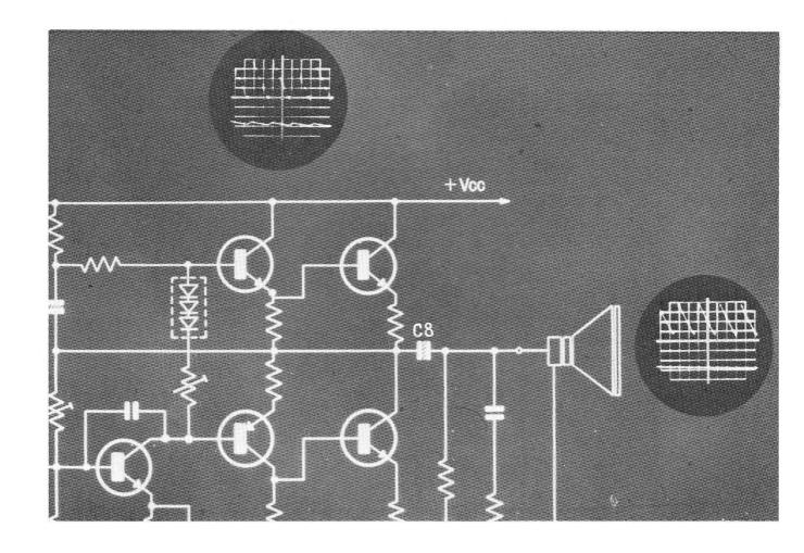
39. SINCE THE UPPER TRANSISTOR IS SHORTED IT OVERLOADS THE POWER SUPPLY AND CAUSES HUM IN THE SPEAKER. THE REASON YOU SUSPECT THE UPPER TRANSISTOR TR5 AND NOT TR4 IS BECAUSE TR5 HANDLES THE POSITIVE COMPONENT OF THE SIGNAL BEING AMPLIFIED. THE ONLY PLACE THE RIPPLE COMPONENT CAN GO IS THROUGH THE COUPLING CAPACITOR C-8 AND THE SPEAKER TO GROUND. THIS IS WHY WHEN YOU HEAR A BUZZING SOUND THROUGH THE SPEAKER YOU SUSPECT THE UPPER TRANSISTOR OF THE PAIR IS SHORTED.
