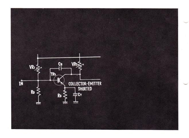
22. LET'S CONSIDER THE CASE WHERE THE COLLECTOR AND THE EMITTER OF TRANSISTOR 2, ARE SHORTED.
