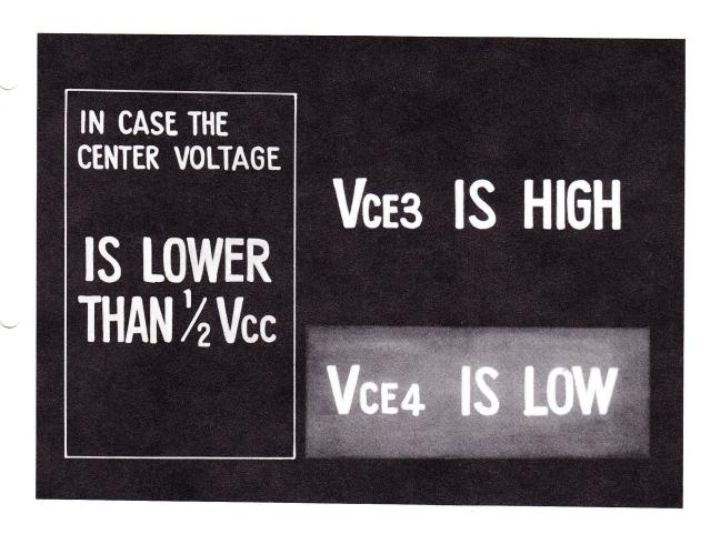
21. WHEN THE CENTER VOLTAGE IS LOWER THAN  $1/2~V_{CC}$ , IT MAY BE THAT THE VOLTAGE BETWEEN THE COLLECTOR AND THE EMITTER OF TRANSISTOR 3, OR  $V_{CE3}$ , IS HIGH, OR IT MAY BE THAT THE VOLTAGE BETWEEN THE COLLECTOR AND THE EMITTER OF TRANSISTOR 4,OR  $V_{CE4}$ , IS LOW.
