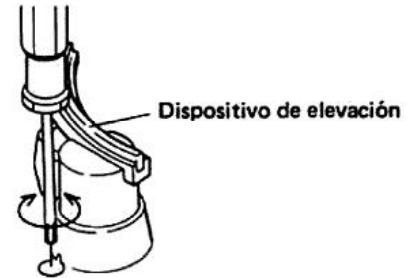
Fig. 12-2 Ajuste de la elevación del brazo
