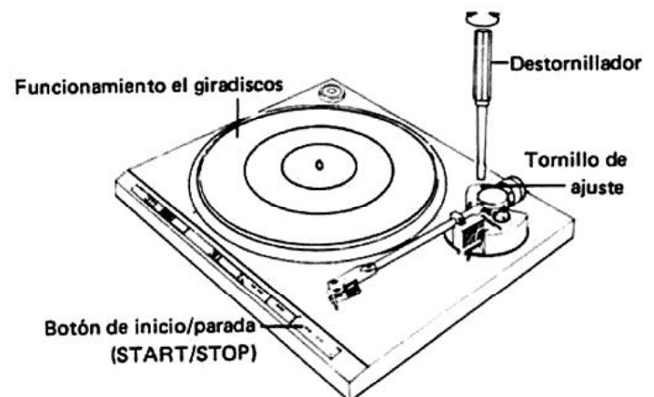
Fig. 12-3 Ajuste del punto de descenso de la aguja
