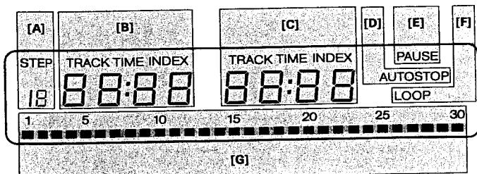
[A] STEP Nummer des aktuellen Programmschrittes; im Programmiermodus blinkt der Schriftzug STEP; im normalen Abspielmodus ist diese Anzeige nicht sichtbar.
