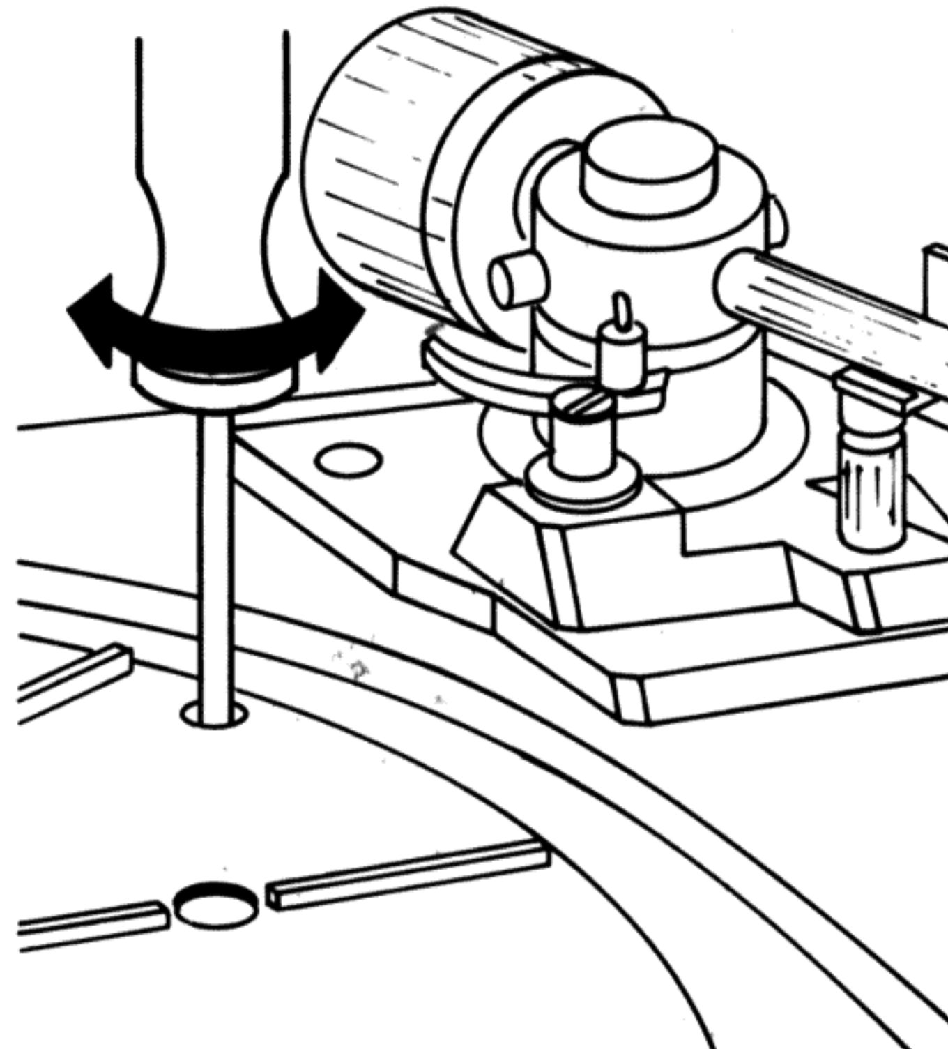
Drehung im Uhrzeigersinn: Verschieben des Abhebepunktes nach innen.
