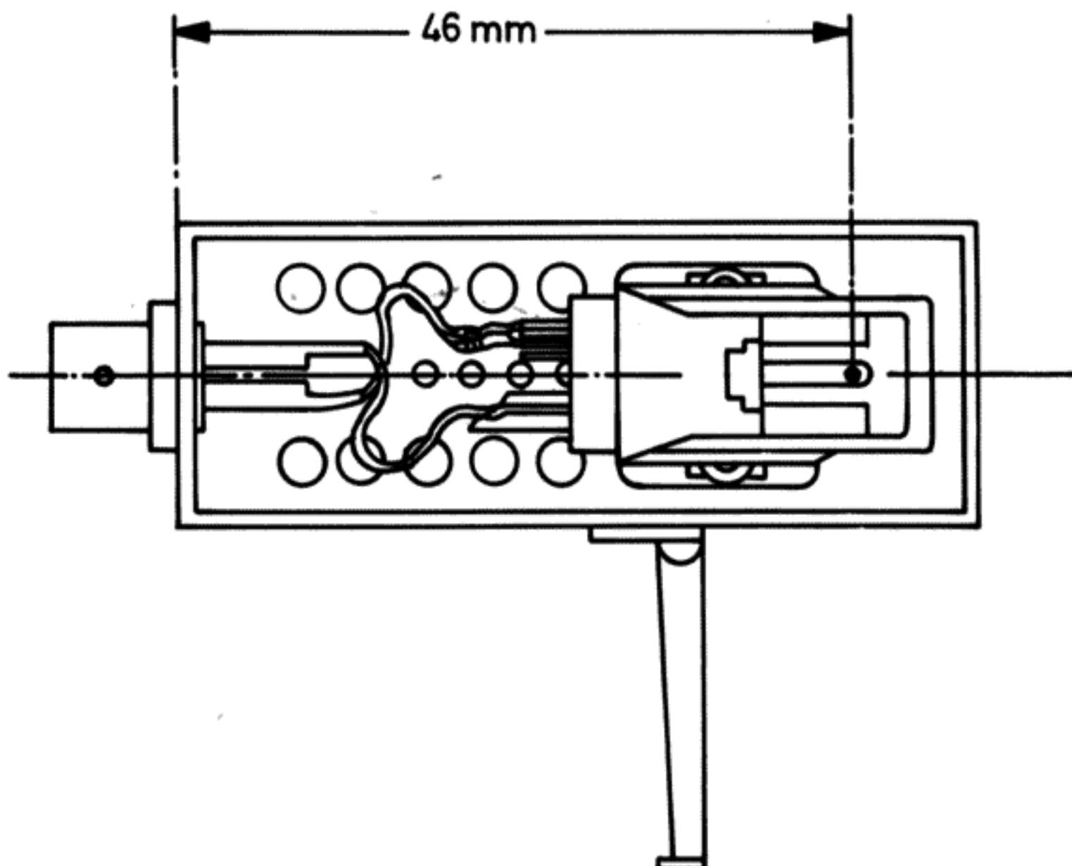
Beim Einstellen und Festziehen der Montageschrauben ist auf die exakte Ausrichtung des Abtastsystems zur Längsachse des Systemträgers zu achten.
