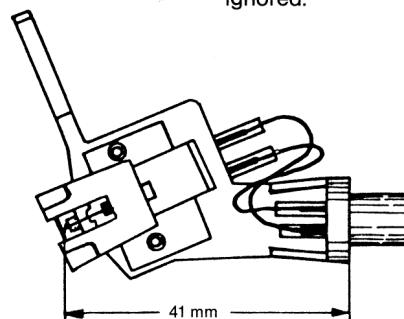
Beim Einstellen und Festziehen der Montageschrauben ist auf die exakte Ausrichtung des Abtastsystems zur Längsachse des Systemträgers zu achten.
