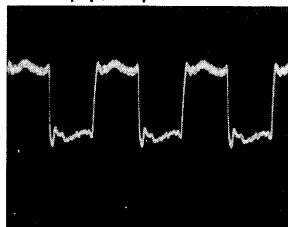
42 IC102 20 pin 6Vp-p, 0.05μs
