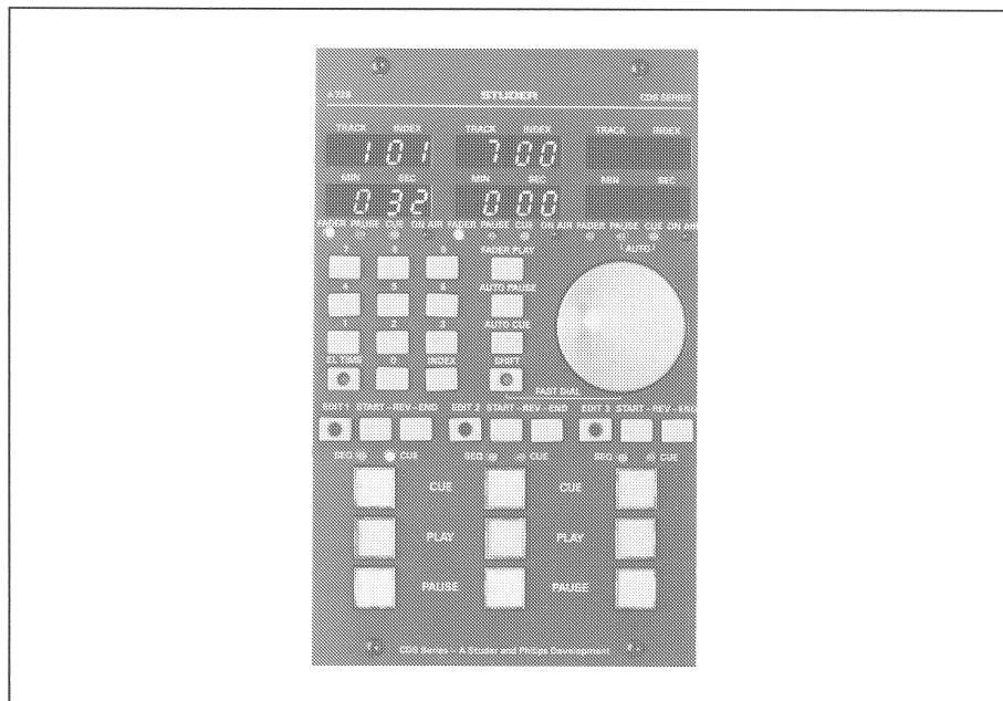
Fig. 1. Frontansicht des Controllers A 728. Die Aufteilung in Edit- und Steuerfelder ist klar erkennbar.
