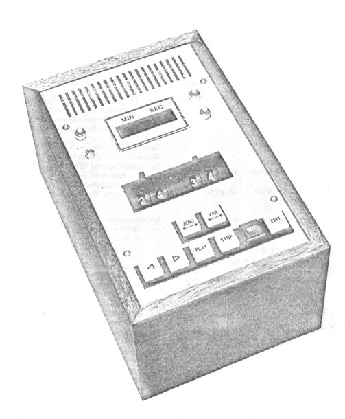
Die A80-Vorwahleinheit ermöglicht ein schnelles und präzises Auffinden einer vorprogrammierten Bandstelle. Durch einfachen Tastendruck wird eine frei gewählte Bandzähler-Nullstellung oder eine vorgewählte Bandzeit automatisch aufgesucht. Bei normal eingestellten Bremszeiten erfolgt der Einstellvorgang ohne Überfahren der vorgewählten Bandposition.
