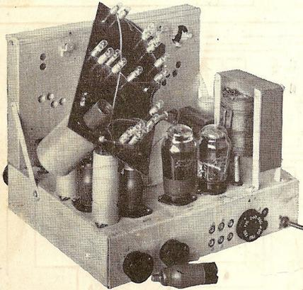
Alle justeringer kan foretas uten å demontere apparatet. Som indikator brukes et tonefrekvens-måleinstrument koblet over uttaket for ekstra høttaler. Instrumentets utslag skal være ca. 0,5 volt. Selektivitetskontrollen skal stå i stilling 2 og volumkontrollen på maksimum.
