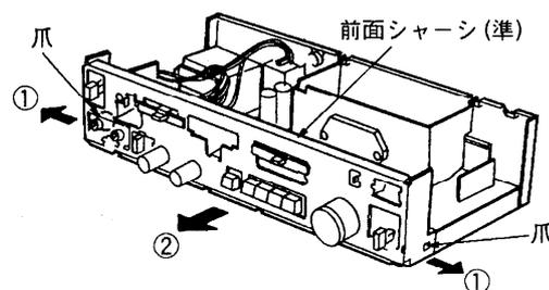
4. 前面シャーシ (準) の両端を矢印①の方向に少し広げて爪 2箇所を外し、前面シャーシ (準) を矢印②の方向に少し引き出す。
