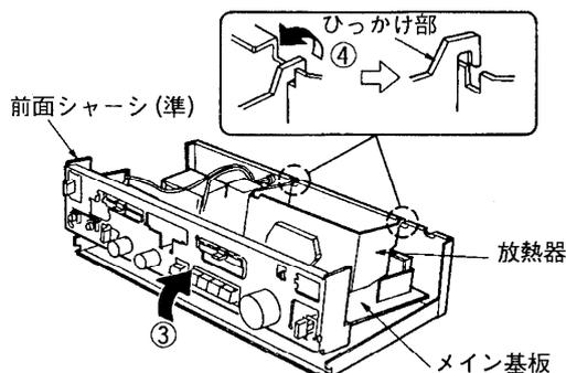
5. 前面シャーシ (準) とメイン基板を矢印③の方向に浮かして放熱器のひっかけ部を矢印④の方向に外す。
