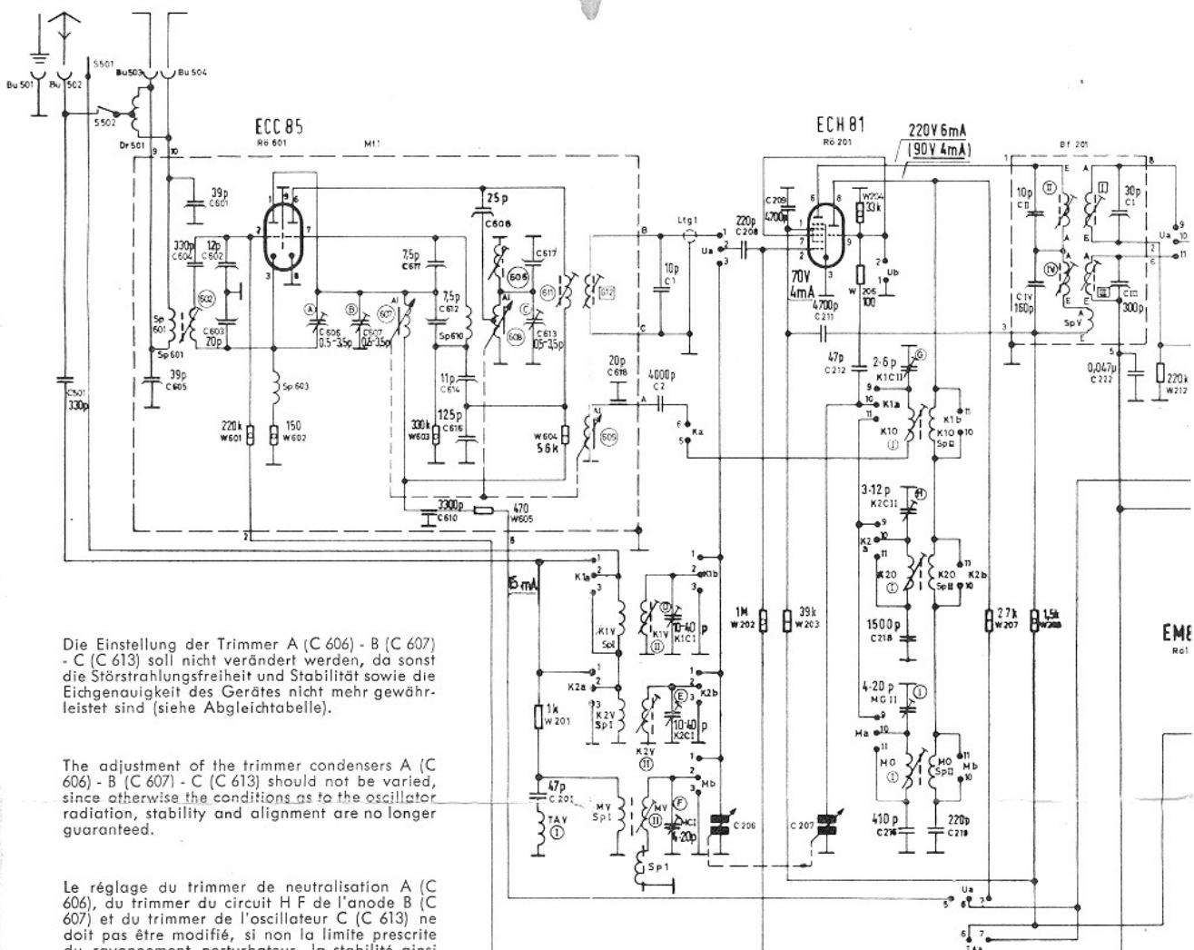
Die Einstellung der Trimmer A (C 606) - B (C 607) - C (C 613) soll nicht verändert werden, da sonst die Störstrahlungsfreiheit und Stabilität sowie die Eichgenauigkeit des Gerätes nicht mehr gewährleistet sind (siehe Abgleichtabelle).
