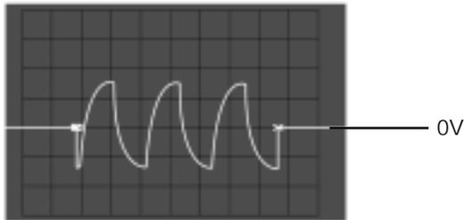
• Forma de onda na bobina de focus no pino 1 e 2 do IC803 e sinal do FOK no pino 40 do IC801 quando a procura está sendo feita.
